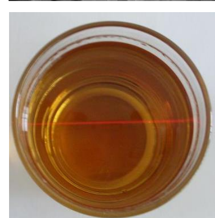
Granule czystego srebra i nano-srebro. Kolooid nano-srebra z widocznym promieniem lasera.
